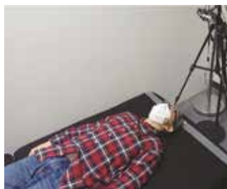
▲レーダーによる呼吸・心拍の計測のセットアップ
